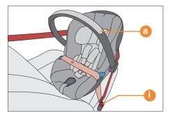
注意! 好孩子Idan系列婴儿安全座 椅提篮可用于所有采用三点式自动收缩 安全带的汽车座椅。 我们一般建议在汽 车后座上使用婴儿安全座椅提篮。如果 在前座上使用,一旦发生事故,婴儿将 要面临非常高的风险。
