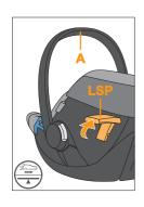
• 将流线型侧撞防护系统(**L.S.P**) 向上抬起,以提高侧面碰撞过程中 的侧面保护。
